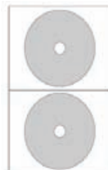
F.TO Ø 117,5 - FORO Ø 17 CON ADESIVO COPRENTE LC235C
